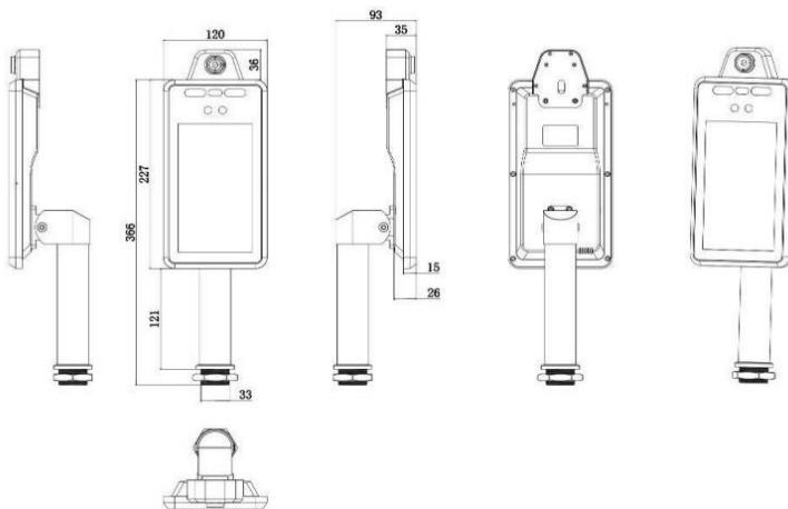
Тепловизионный комплекс «Термовед 521 МЕ Контроль», может быть связан с компьютером проводной или беспроводной связью. Питание 12 В. Позволяет использовать прибор на транспорте или автономно, от стандартного аккумулятора 12 В.
