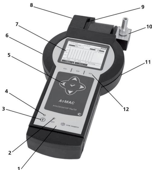
Рисунок 1. Внешний вид анализатора пыли «Атмас»
