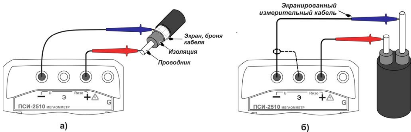
Рисунок 2.11 - Измерение сопротивления изоляции
