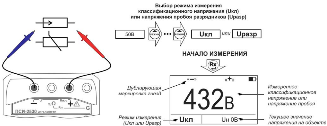
Рисунок 2.10 - Измерение классификационного напряжения или напряжения пробоя разрядников
