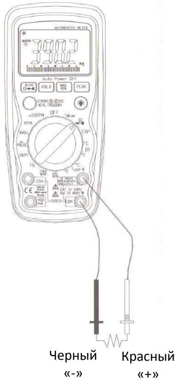
**Режим измерения – проверка диодов (  )**
