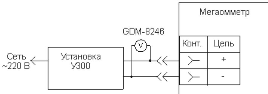
Рисунок 7 - Схема проверки погрешности при измерения напряжения
