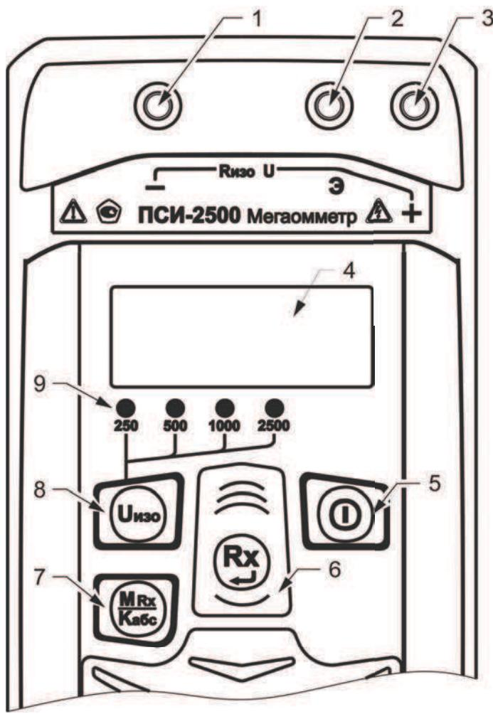
Рисунок 2 - Расположение разъёмов подключения и органов управления
