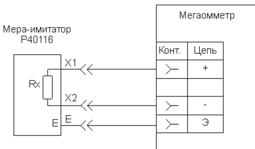
Рисунок 6 - Схема определения погрешности измерения сопротивления изоляции
