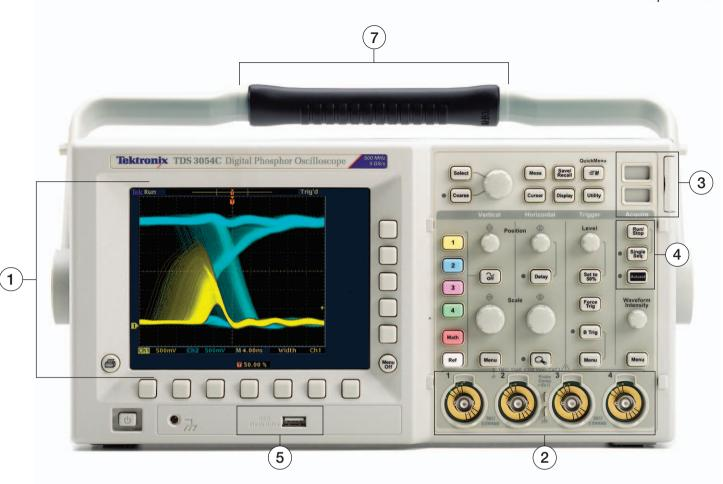
1 Осциллограф с цифровым люминофором – более быстрое обнаружение и устранение неполадок в разрабатываемой системе с помощью осциллографа серии TDS3000C со скоростью непрерывного захвата осциллограмм 3 600 осциллограмм/с и градацией яркости в режиме реального времени. Высокая скорость непрерывного захвата осциллограммы экономит время за счет быстрого выявления природы неполадок для их последующей локализации с помощью расширенного выбора видов запуска.
