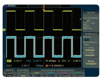
Осциллограф с цифровым люминофором TDS3000C с модулем тестирования предельных значений TDS3LIM прекрасно подходит для производственных испытаний, когда требуется быстро принимать решения типа «годен/не годен».
