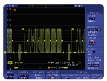
Функция настраиваемого запуска на видеосигналы позволяет осциллографу серии TDS3000C выполнять синхронизацию по таким стандартам, как RS-343 (частота сканирования 26,2 кГц).
