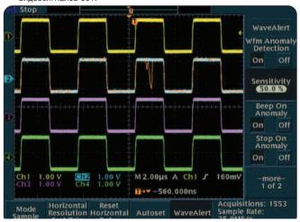
Функция обнаружения аномалий осциллограммы WaveAlert оповещает обо всех осциллограммах, отличающихся от «нормального» вида, например о выбросе в канале 2.
