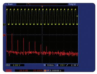
▶ Поиск случайного шума в цепи с использованием функции БПФ осциллографа серии TDS3000C.
